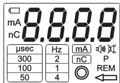
La pantalla sirve para visualizar sea la intensidad de la corriente (mA), sea la carga asociada a cada impulso (nC), así como los parámetros de funcionamiento seleccionados (duración de impulso, frecuencia, unidad de medida de visualización, botón de control de la corriente activa, posibles alarmas con respecto a la batería).
