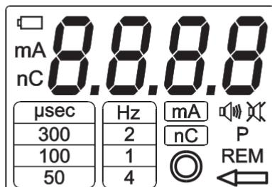
L'écran est utilisé pour afficher soit l'intensité de courant (mA), soit la charge associée à chaque impulsion (nC) ainsi que les paramètres de fonctionnement sélectionnés (durée de l'impulsion, fréquence, unité de mesure de visualisation, bouton de contrôle du courant activé, éventuelles alarmes concernant la batterie).
