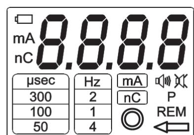
O ecrã é utilizado para visualização da corrente ou carga associada a cada impulso e para exibir os parâmetros de funcionamento selecionados (duração do impulso, frequência, unidade de medida da visualização, botão de controlo da corrente ativa e eventual alarme da bateria).
